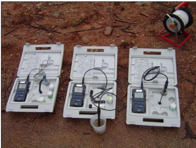
**Figura 5.3** – Equipamentos utilizados para medição *in situ* de parâmetros físico-químicos da água (autor: Azevedo, J.M.M., 2012).
