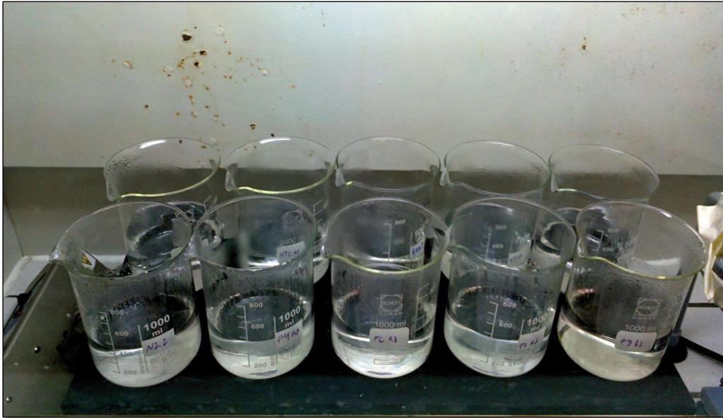
**Figura 5.5** - Tratamento das amostras de rádio em placa de aquecimento.
