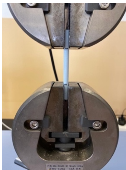
Figura 2.1. - Equipamento utilizado no ensaio de Resistência à Tração.
