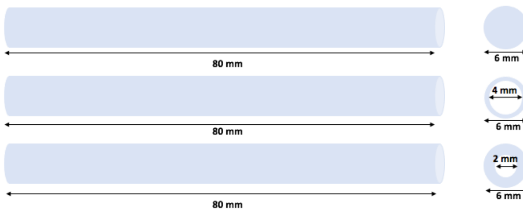
Figura 2.3. - Dimensões dos provetes de PLA com geometria cilíndrica.
