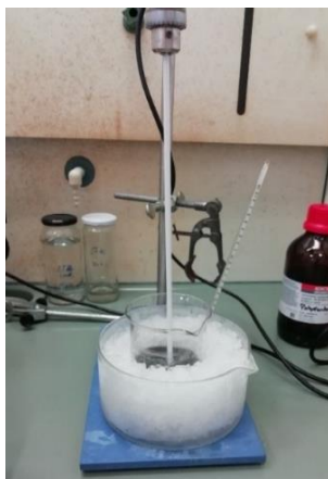
Figura 17 – Montagem experimental utilizada para o revestimento das nanopartículas com sílica (P1).
