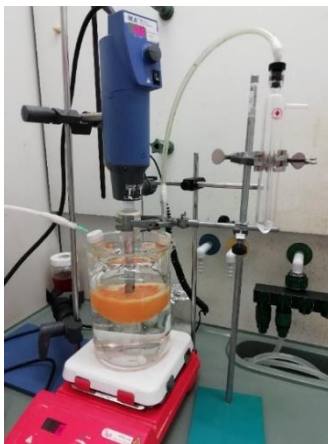
Figura 15 – Montagem experimental utilizada para a síntese dos SPION – primeira microemulsão.
