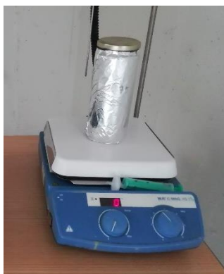
Figura 22 – Montagem experimental para o teste de adsorção do SMX sem luz solar na presença do catalisador Degussa P25 na ausência de luz solar.
