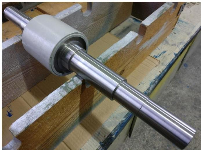
Figura 34 – Rotor e veio da máquina.
