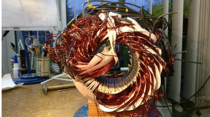
Figura 32 – Enrolamentos do estator da máquina em construção.
