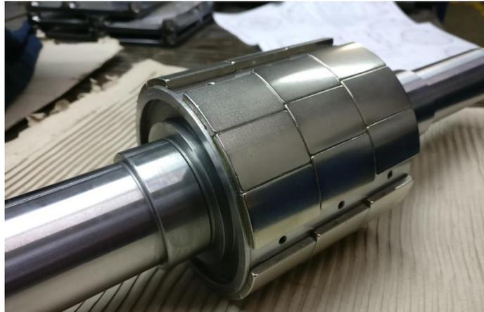
Figura 33 – Implementação dos ímãs permanentes na máquina.
