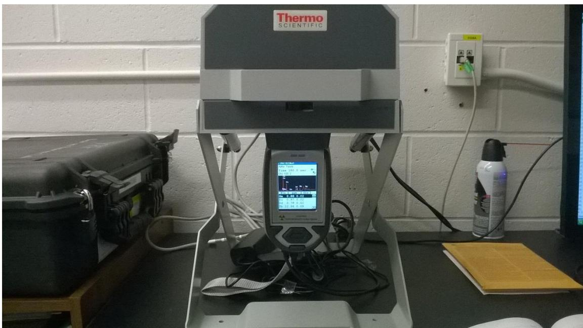
Figura II.4 - Equipamento de FRX Thermo Fisher Scientific Niton XL3t acoplado à bancada de análise portátil.
