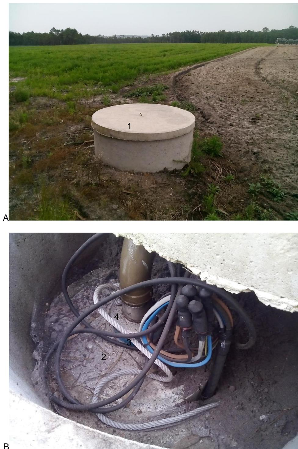
Figura 4.3 – A - Furo F16 e sua envolvente (1) Manilha e tampa de proteção; B – Pormenor do Furo F16 (2) – Isolamento superficial; (3) Tubo PVC; (4) – Tampa de proteção.
