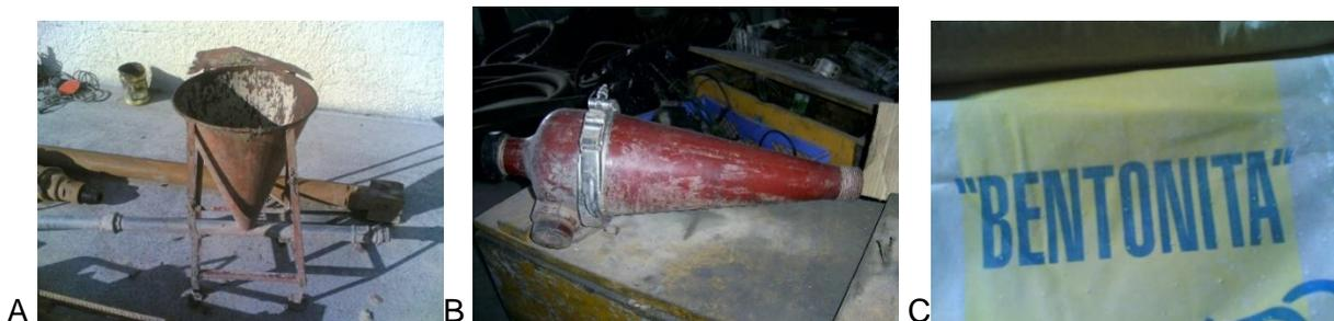
Figura 4.13 – A – Misturador de Bentonite; B – Hidrociclone; C – Bentonite.
