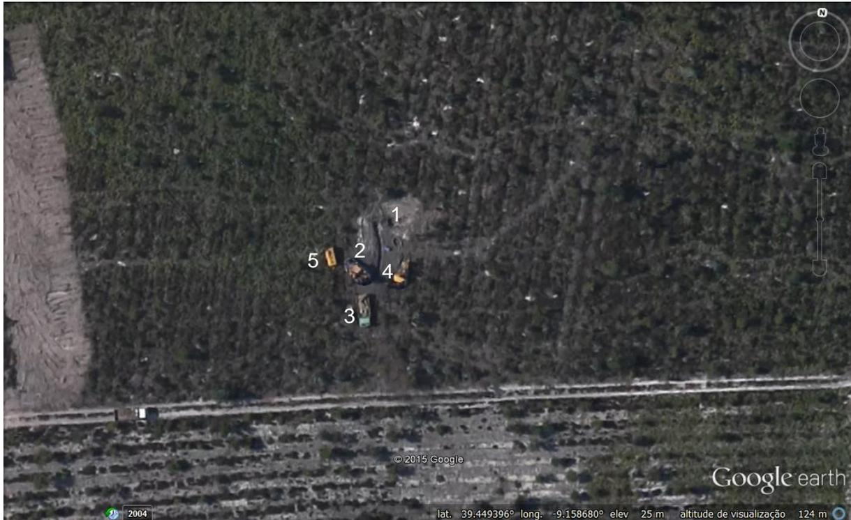
Figura 4.7 – Fotografia aérea da execução do furo F20; (1) Tanques de decantação de areias, (2) máquina de perfuração, (3) veículo de apoio, (4) bomba de lamas, (5) compressor para limpeza e desenvolvimento da captação.
