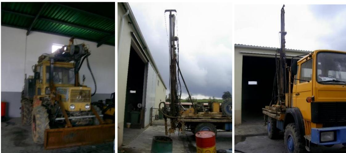
Figura 4.10 - Máquinas de perfuração utilizadas na abertura dos furos na zona em estudo.
