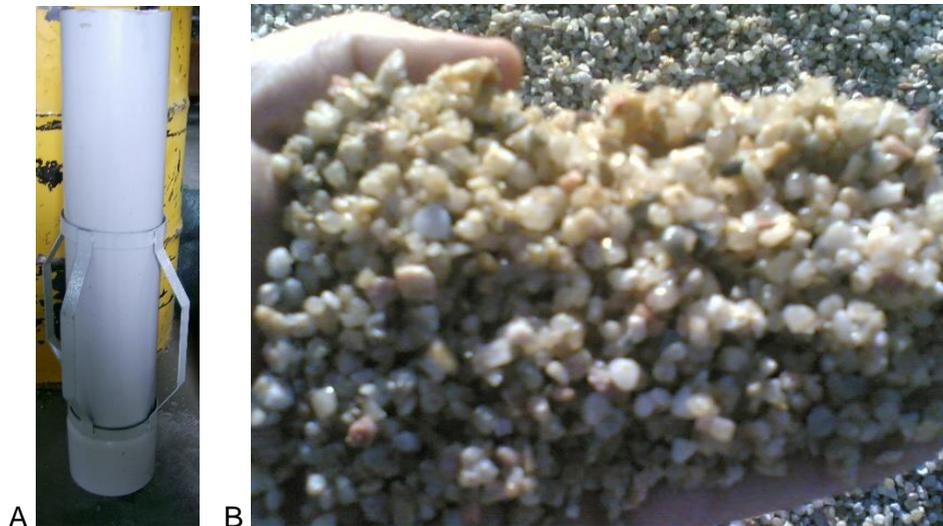
Figura 4.15 – A – Tubo PVC para entubamento do furo e centralizador; B – Seixo calibrado 3/5mm para maciço filtrante.
