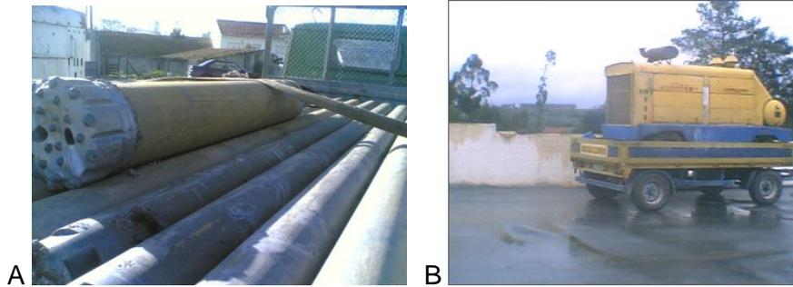
Figura 4.14 – A – Martelo fundo furo e bit de perfuração; B – Compressor alta pressão.
