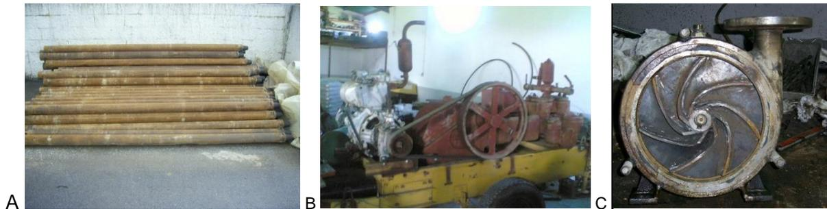
Figura 4.12 – A – Varas de perfuração; B – Bomba de lamas de pistons; C – Bomba de lamas centrifuga.
