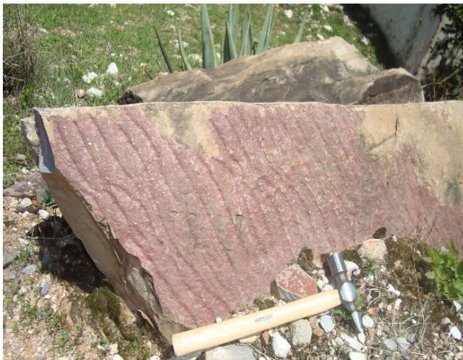
Figura 38 – Blocos de quartzito vermelho exibindo faces com marcas de ondulação ‘‘ripple marks’
