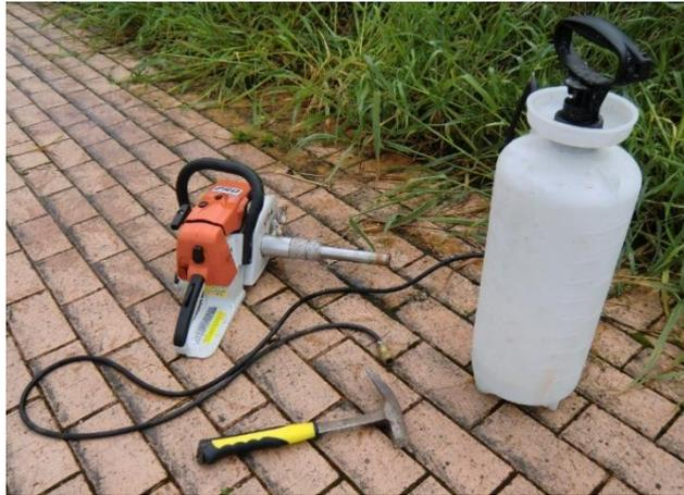
Figura 22 - Sonda portátil com coroa adiamantada e bomba de água para arrefecimento.
