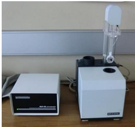
Figura 26 - Balança de susceptibilidade magnética, à direita e unidade de conversão de dados, à esquerda.
