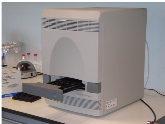
Figura 2.27 Unidade Applied Biosystems 7500 Real-Time PCR System, para quantificar os níveis de expressão dos genes.
