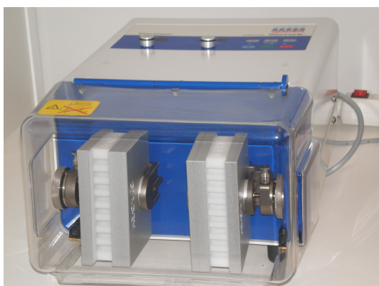
Figura 2.25 Unidade Tissue Lyser para disrupção e homogeneização dos tecidos
