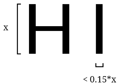
Figura 23: Ilustração do Standard 703.2.6 Stroke Thickness (U.S. Department of Justice, 2010). A largura da letra “I” maiúscula não deve exceder 15% da altura dos caracteres. Os caracteres apresentados para ilustrar esta relação pertencem novamente ao tipo de letra Lato desenhado por Lukasz Dziedzic (Google Fonts, s.d.-a). Neste caso a relação é de aproximadamente 14,5%, cumprindo com o proposto.
