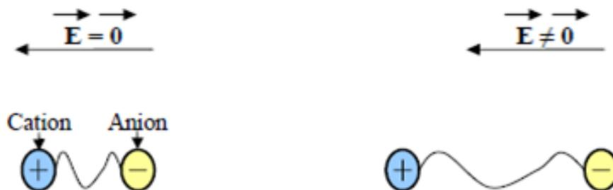
**Figure I.7** : Polarisation atomique ou ionique
