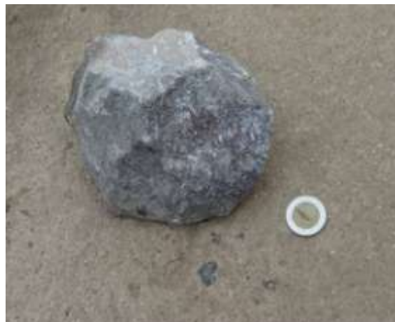
Figura 4.17- Produto extraído: Rochas graníticas - Britas de 0.1 (4,75 a 25 mm); 0.2 (9,5 a 31,5 mm); 0.3 (19 a 50 mm) e amostra de rocha explorada nesta pedreira.
