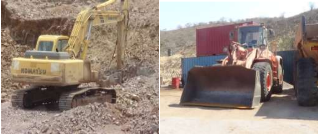
Figura 4.8 – Aspectos da escavadora giratória na frente de desmonte e da pá-carregadora que efectua o carregamento de agregados para os camiões.
