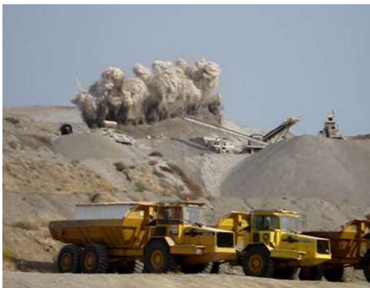
Figura 4.23. Rebetamento de uma pega de fogo na pedreira de Uche.
