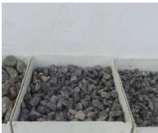
Figura 4.17- Produto extraído: Rochas graníticas - Britas de 0.1 (4,75 a 25 mm); 0.2 (9,5 a 31,5 mm); 0.3 (19 a 50 mm) e amostra de rocha explorada nesta pedreira.
