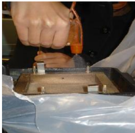
Figura 3.3 – Colocação do contaminante na preparação de uma amostra na caixa de corte. (adaptado Taborda, 2012).
