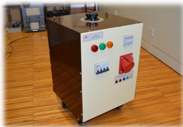
Figura C.17 – Autotransformador usado para regular o nível de tensão de alimentação das cargas
