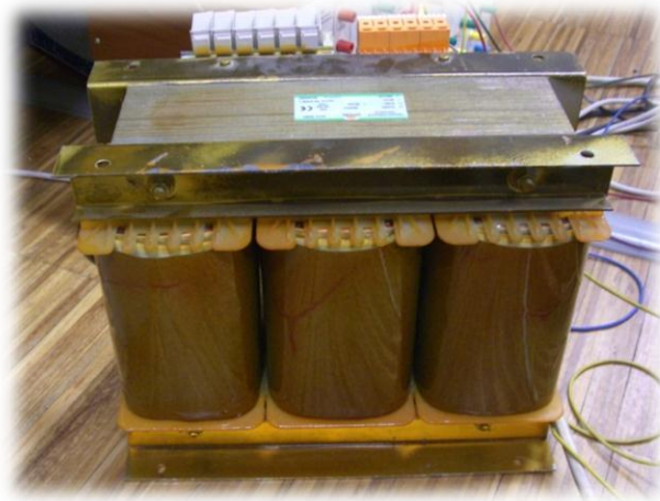
Figura C.21 – Transformador usado como uma carga indutiva. Foi usado um enrolamento de 30mH e um de 40mH
