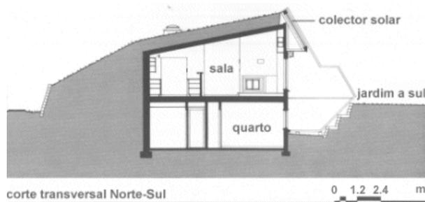
Figura 2.2 – Arrefecimento pelo solo: contacto direto: exemplo de habitação semienterrada (Pessoa, 2009).
