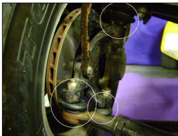
Figura 2.21. Juntas elásticas da suspensão traseira de um automóvel desportivo da marca Caterham .
