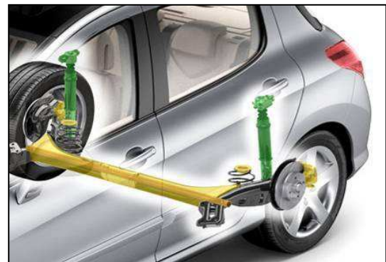
Figura 1.7. Sistemas empregues no eixo traseiro – (à esq.) Eixo Rígido; (à dir.) Eixo oscilante ( Peugeot 308 ).
