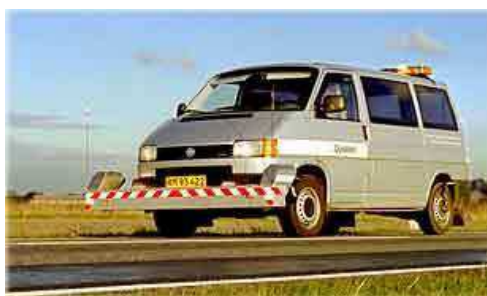
Figura 2.2. Perfilómetro de alta velocidade Dynatest 5051 MARKIII.
