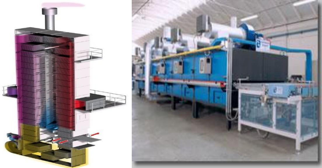
Figura 9 - Secadores rápidos, vertical e horizontal
