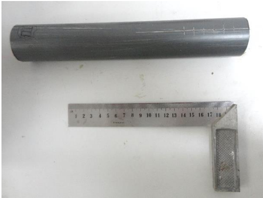
Figura 16 Confinamento cilíndrico em PVC com 31mm de diâmetro e 250mm de altura.
