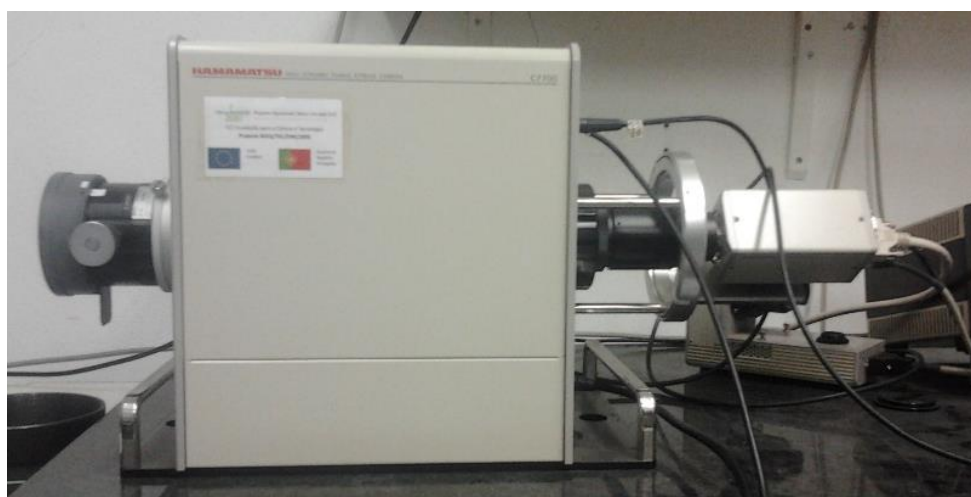
Figura 21 Câmara Eletrónica Ultrarrápida de Varrimento Hamamatsu C7700 acoplada ao Hamamatsu CCD C8484 .
