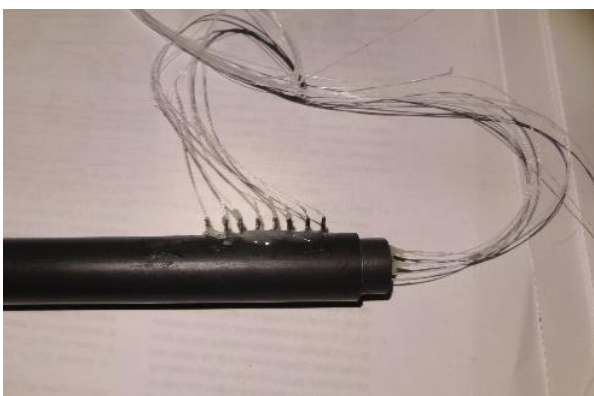
Figura 17 Fotografia do Confinamento com as Fibras Óticas Colocadas num tubo de 15,5mm.
