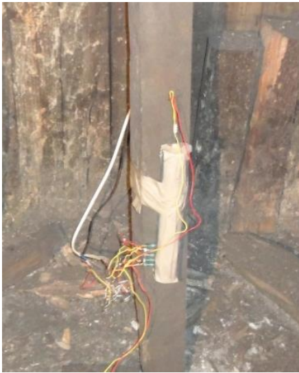
Figura 24 Carga explosiva pronta a detonar no interior da câmara de explosões, com cinco sondas elétricas colocadas ao longo do seu comprimento.
