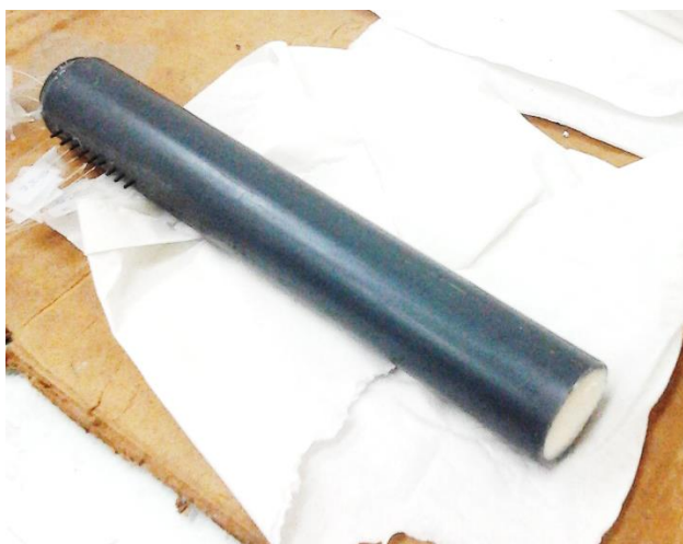
Figura 18 Carga explosiva de 31mm.
