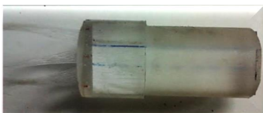
Figura 13 Peça em acrílico com as fibras óticas acopladas.
