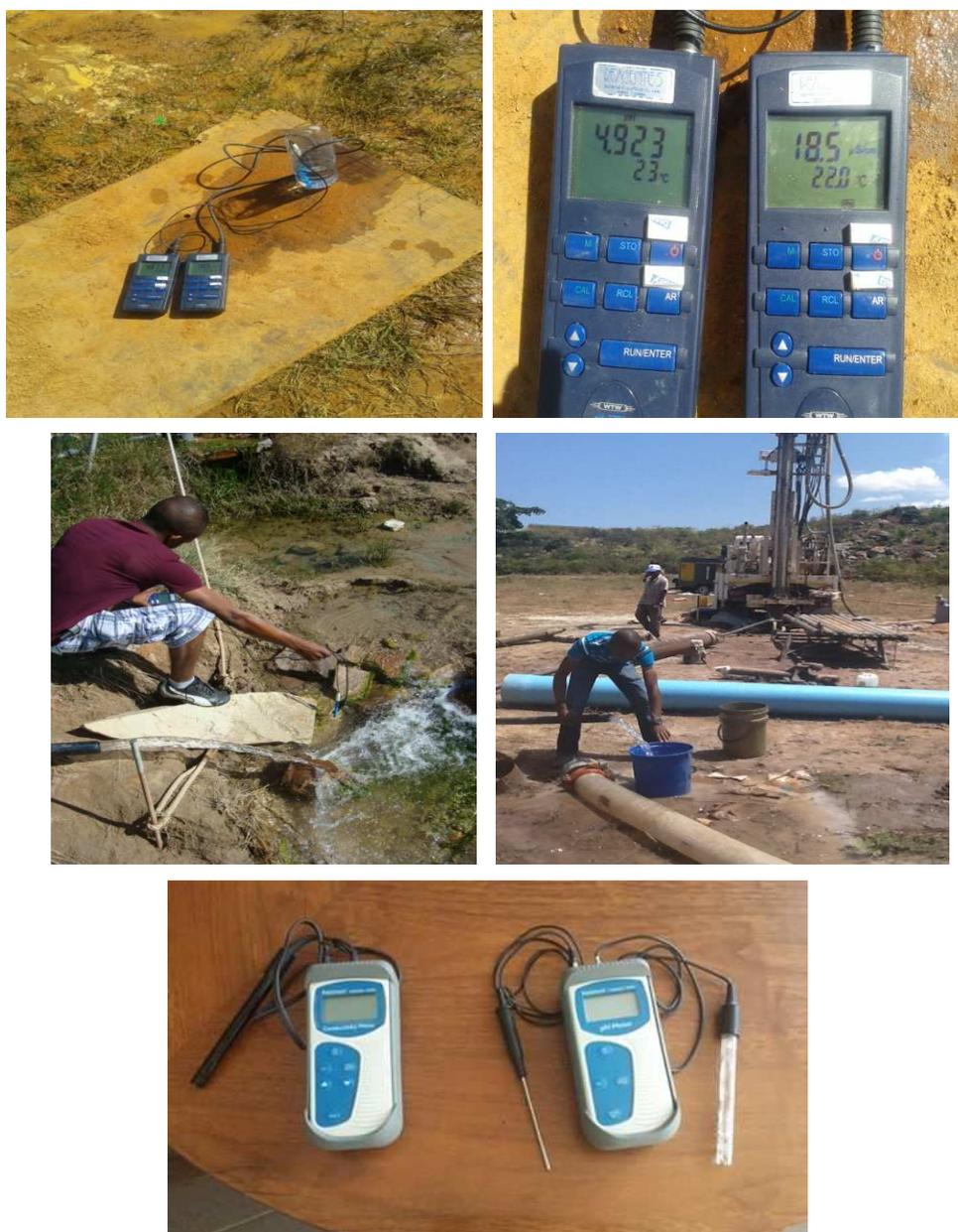
Figura 4.9: Recolha de amostras, medições de parâmetros físico-químicos e equipamentos utilizados.
