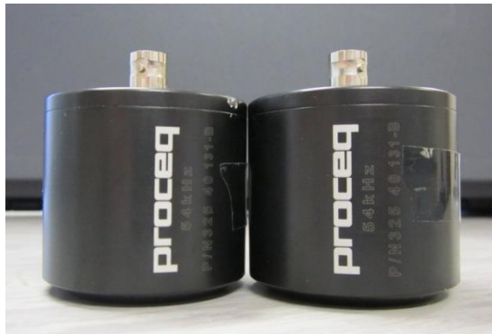
Figura 3.3 - Transdutores de Contacto Proceq de 54kHz utilizados no presente trabalho.
