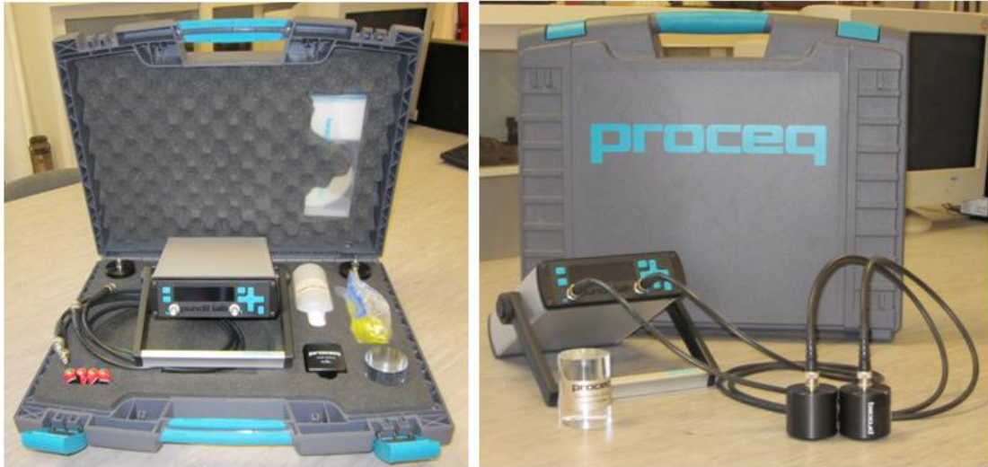
Figura 3.1 - Equipamento de ensaio ultra-sónico Pundit Lab da Proceq, constituído pela unidade de leitura de dados, bloco de calibração, transdutores, cabos de conexão, pasta de acoplamento, carregador, documentação e mala de transporte.
