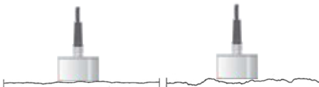
Figura 2.14- Esquema ilustrativo do ajuste de um transdutor em superfícies com diferentes graus de rugosidade.
