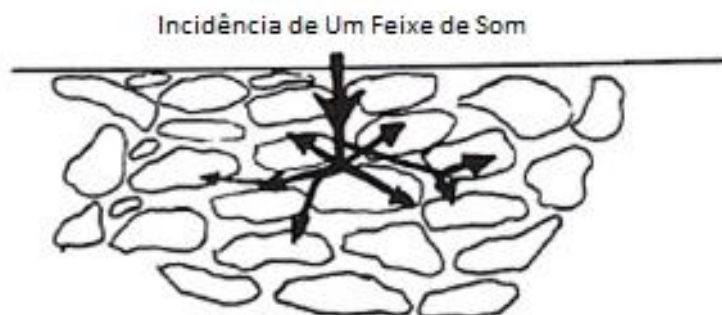
Figura 2.13 - Desenho esquemático da incidência de um feixe de som num material com partículas de diferentes tamanhos. (Drury, 1992)
