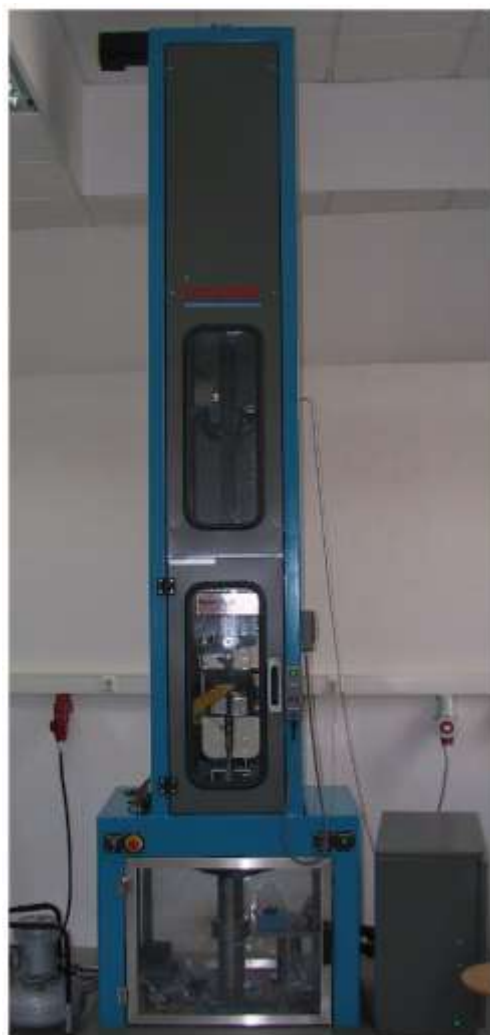
Figura A 3 - Máquina de impacto IMATEK-IM10
