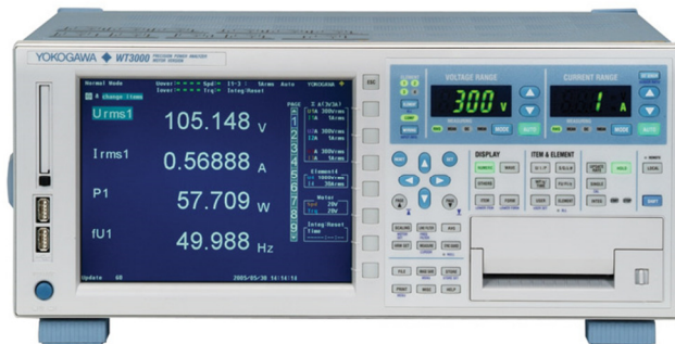
Fig. D.4 – Yokogawa WT3000, utilizado nos ensaios laboratoriais.
