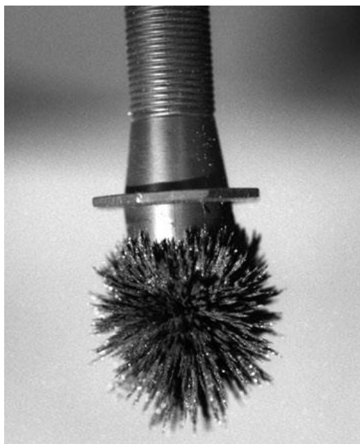
Figura 2. Aplicador de pó magnético [11].
