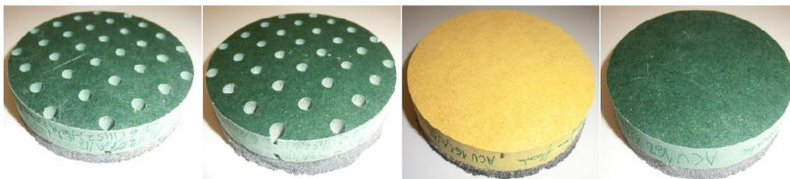
Figura 5.3 – Amostras ACU\_207, ACU\_217, ACU\_161 e ACU\_162, em MDF, com e sem perfuração com espuma colada e flocadas
