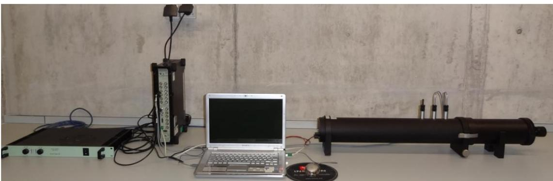
Figura 3.1 – Fotografia do equipamento de ensaio para a determinação do coeficiente de absorção
