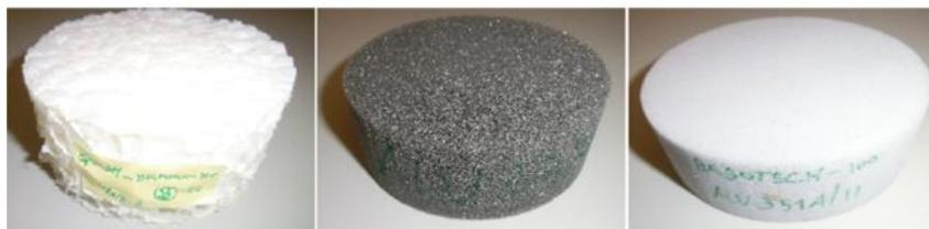
Figura 5.4 – Amostras de ACU\_344 (quash branco), ACU\_333 (espuma de poliuretano) e ACU\_351 (basotect)
