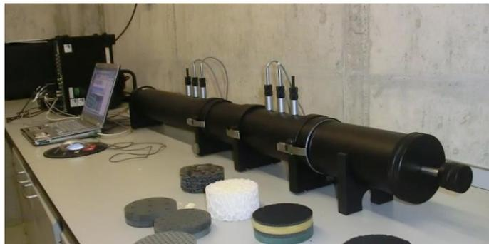
Figura 3.2 – Fotografia do equipamento de ensaio para a determinação da perda por transmissão sonora
