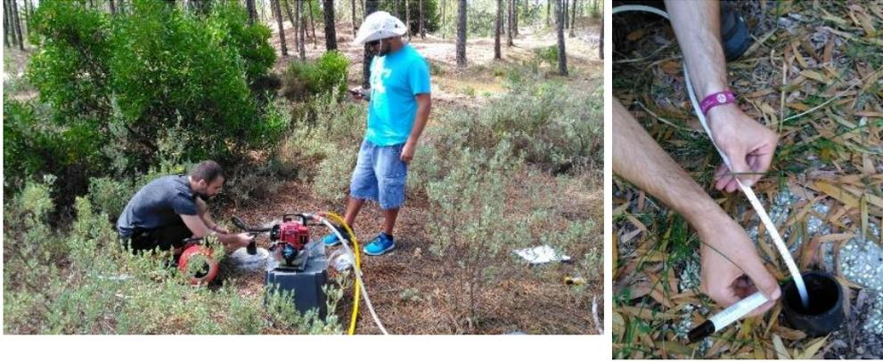
Figura 2 – Ensaio de teste de recuperação após bombagem em *in situ*.
