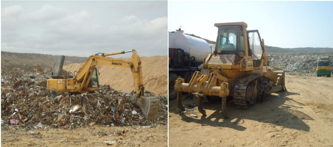
**Figura 4.6** - Máquinas usadas para compactar e enterrar o lixo.
