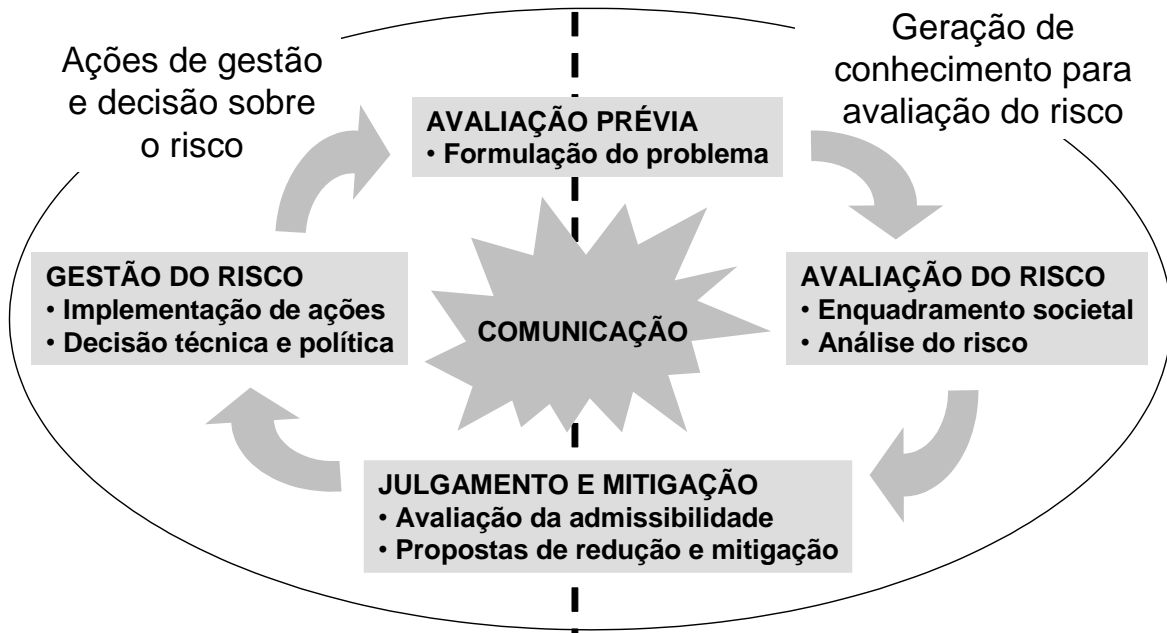
Figura 1.3 Modelo para a governação do risco, segundo o International Risk Governance Council, e apresentado em Tavares (2013).
