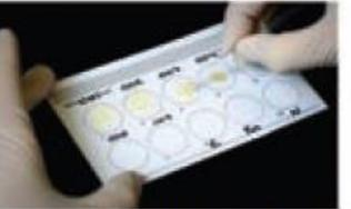
Espalhe as amostras e os controles gentilmente dentro dos círculos, utilizando a extremidade plana do "dispensador".
