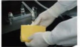
Prepare o equipamento. Umedeça uma esponja e coloque-a na tampa do agitador.
