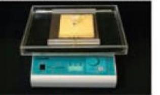
Coloque o cartão no agitador a 100rpm por oito minutos.
