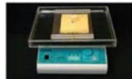
9. Coloque o cartão no agitador a 100rpm por oito minutos.
