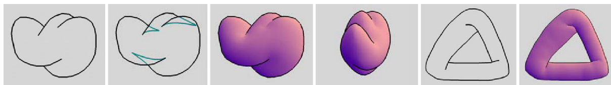
Figura 23. Criação de modelo 3D usando esboço do utilizador e contornos escondidos assumidos pelo sistema (Karpenko & Hughes, 2006).
