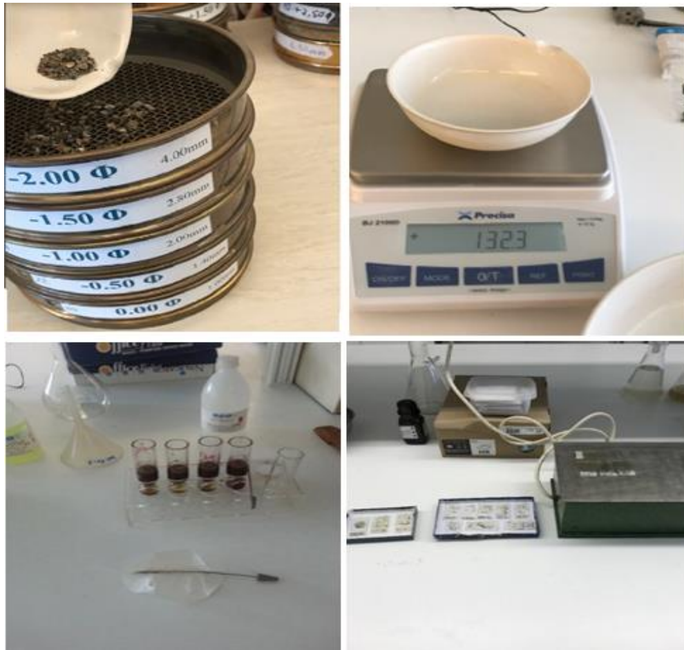
Figura 7 – Processo de crivagem, pesagem e separação de minerais pesados das amostras de sedimentos, por meio do líquido denso (politungstato de sódio) para a montagem das respectivas lâminas densas.
